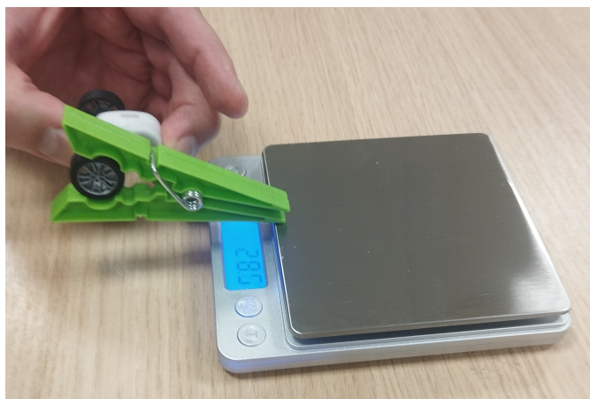
Joonis 1: Pöördemomendi mõõtmine pesulõksu ja kaaluga.
